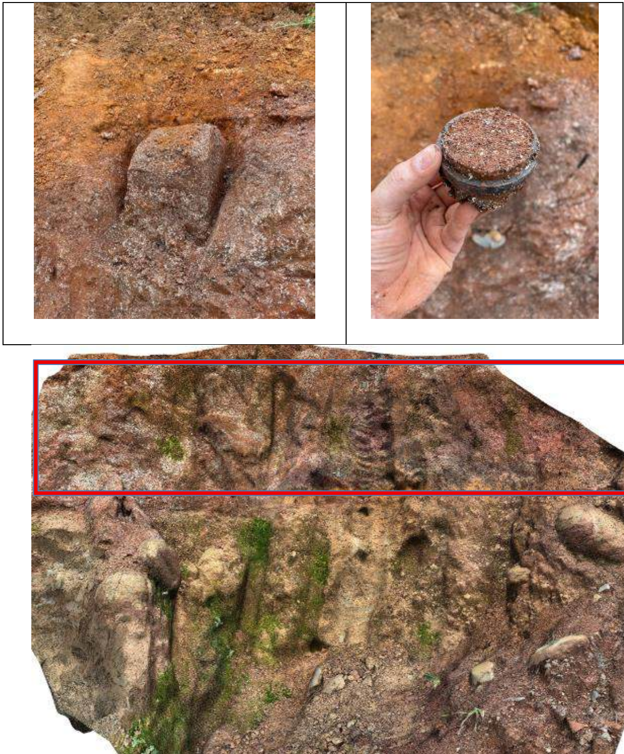
Figura 3.4 – Retirada de amostras do solo amigdalóide avermelhado
