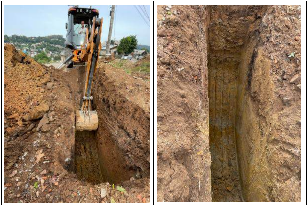
Figura 2.24 – TR01- materiais presentes na trincheira, solo amigdalóide avermelhado encontrado a ~4,0m de profundidade.
