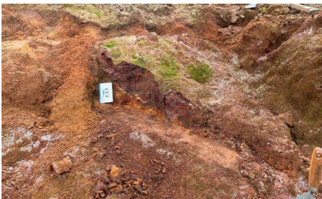
Figura 2.19 – Superfície de ruptura
