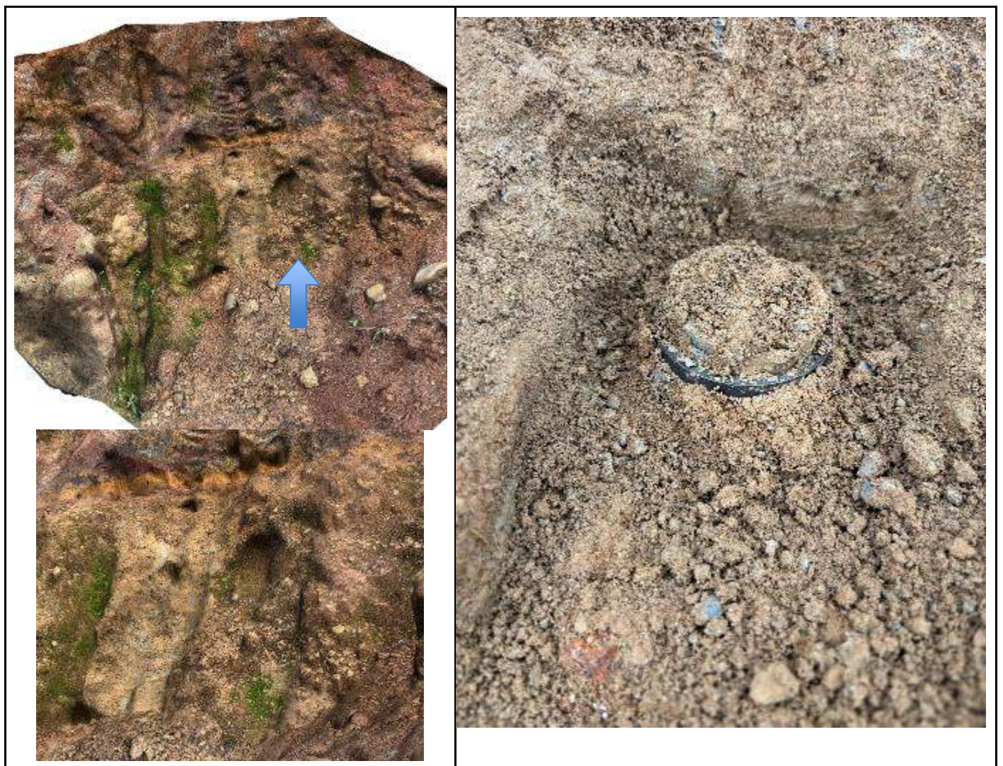
Figura 3.7 – Retirada de amostras do solo amigdalóide cinza menos alterado
