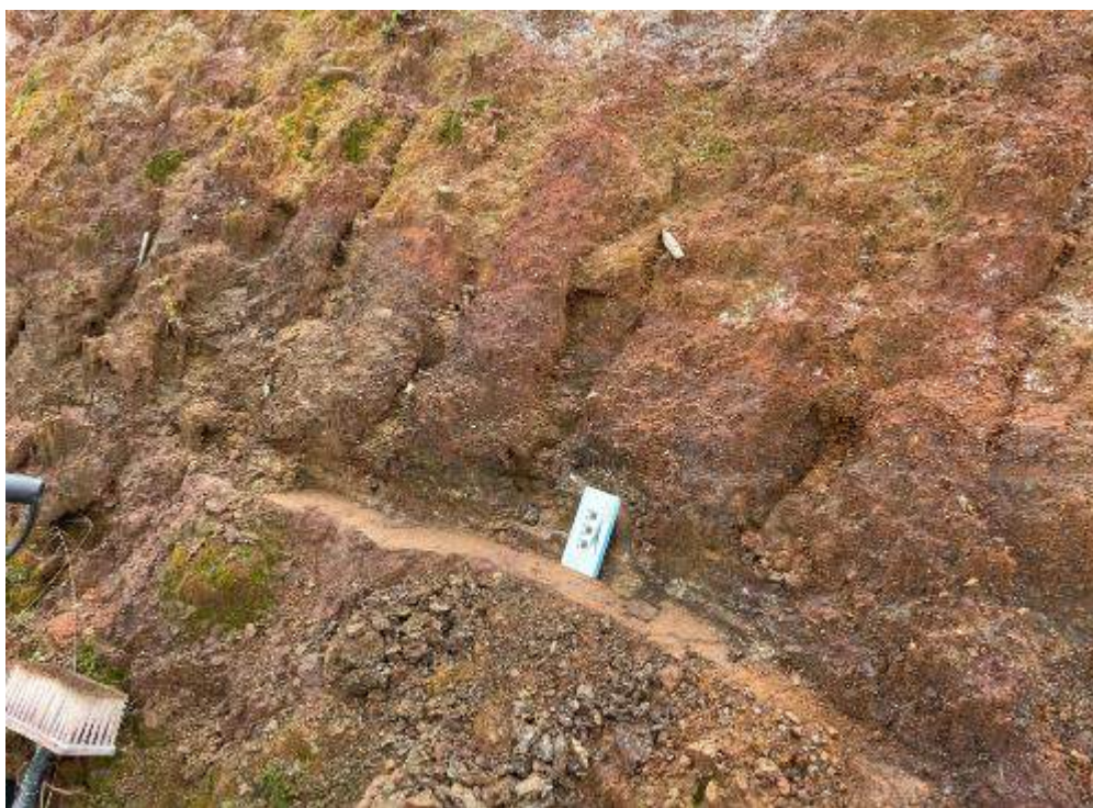
Figura 2.19 – Superfície de ruptura
