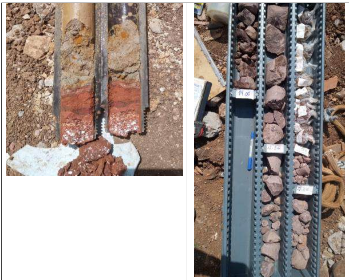
Figura 2.30 – Solo amigdalóide SM07 (6 m de profundidade – cota 776m ) e caixa de testemunhos da sondagem
