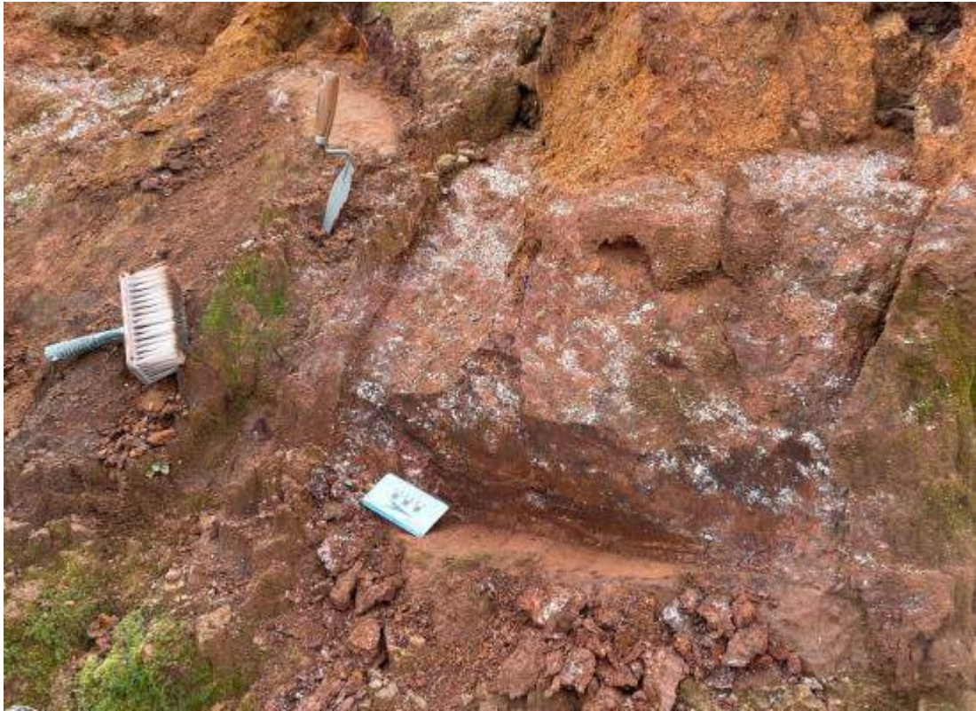
Figura 2.21 – Trincheira paralela à rua Guilherme Dal Ri - solo amigdalóide cinza claro sobre solo avermelhado.
