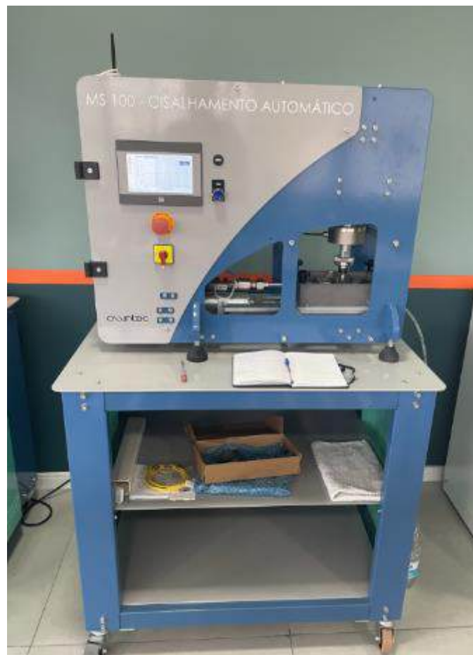
Figura 3.2 – Equipamento de cisalhamento direto de laboratório
